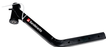
2- Conjunto dianteiro pré-montado do quadro
